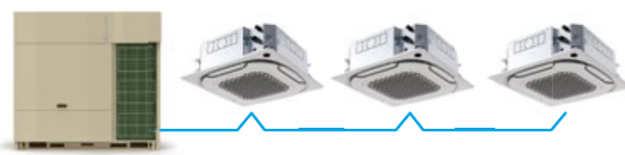
Традиционная схема подключения «Шлейф»
